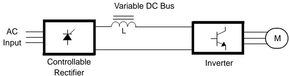
Figure AC-3. CSI Block Diagram
