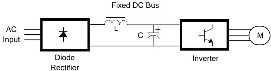
Figure AC-5. PWM Block Diagram
